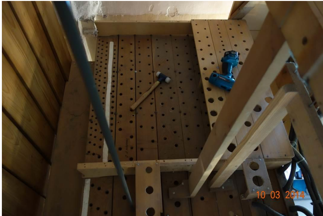
Bild oben: Schwellwerkslade nach Ausbau der Pfeifen
