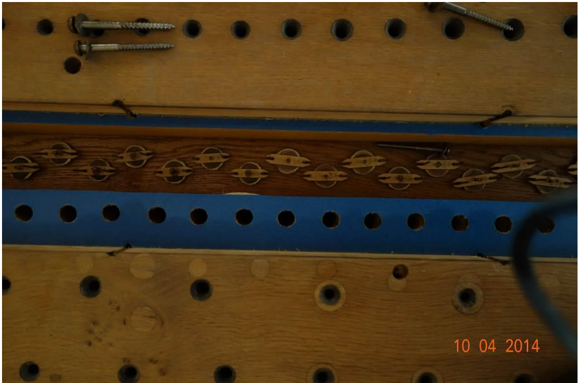
Fotos: Geöffnete Registerkassette mit Sicht auf die Kegellventile
