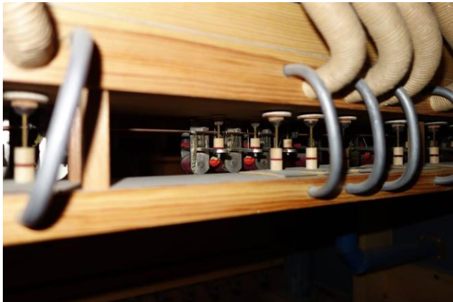
Foto der elektropneumatisch angesteuerten Spiel und Registertraktur
